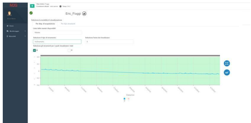
Rappresentazione delle misure degli inclinometri.
