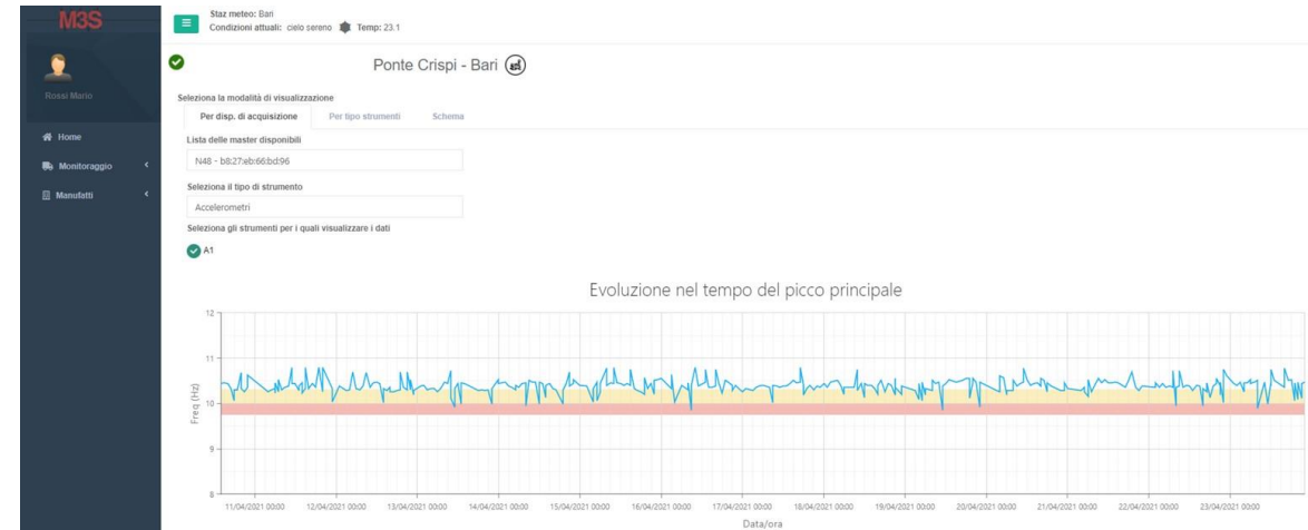
Rappresentazione della stima della frequenza propria della struttura nel tempo.
